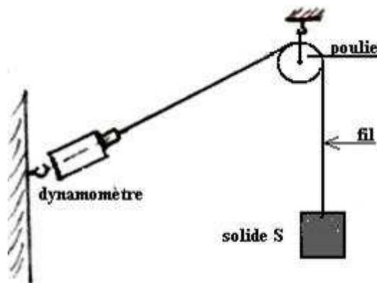
Avec le montage ci-dessus, le dynamomètre mesure le poids de S (si la masse du fil et si les frottements de la poulie sont négligeables)
